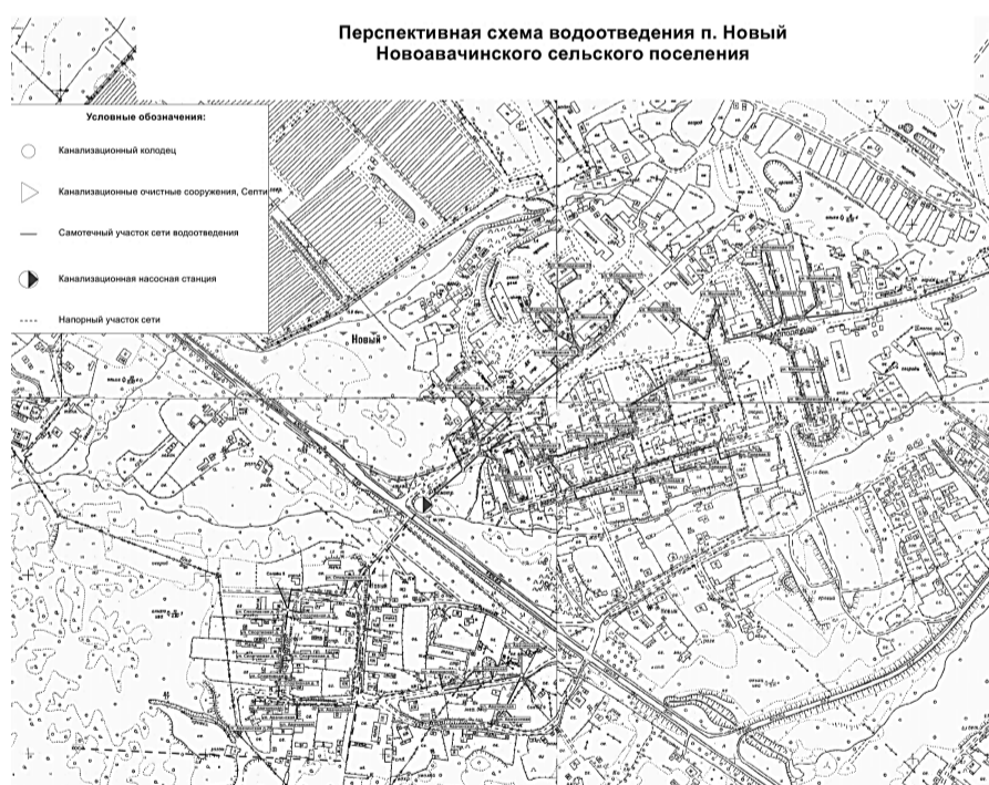
Рисунок 32 – Территориальное расположение и схема канализационных сетей поселка Новый Новоавачинского сельского поселения
