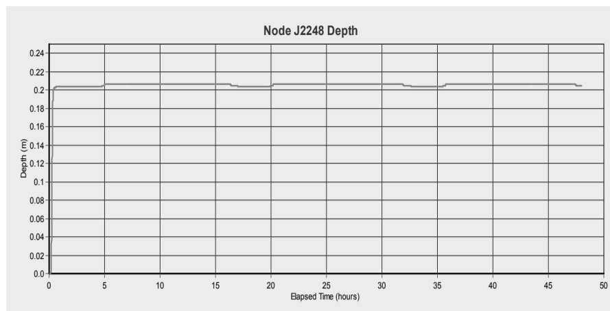
Рисунок 38 – Модельный график заполнения камеры (узел J2248) на самотечном коллекторе Пионерского сельского поселения, при поступлении в него сточных вод от поселка Новый Новоавачинского сельского поселения
