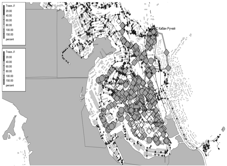
Рисунок 9 – Зона водоснабжения водозабора «Кабан-ручей»
