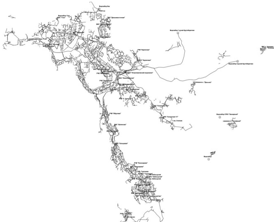
Рисунок 30 – Общий вид системы водоснабжения г. Петропавловска-Камчатского.
