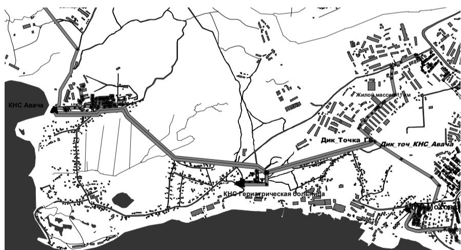
Рисунок 49 – Гидравлическая модель проектируемых напорных коллекторов от КНС «Авача» до камеры гашения на самотечном коллекторе Ду = 300 мм (проект перепуска стоков от жилого массива 11 км)
