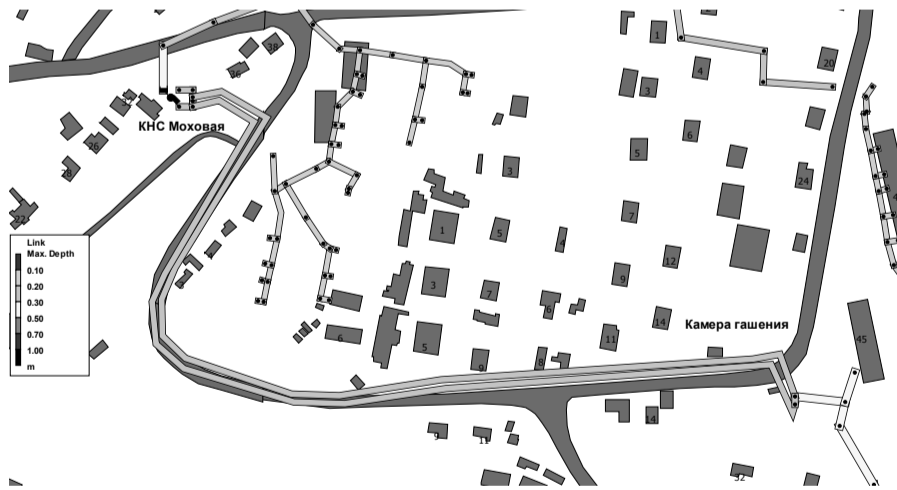
Рисунок 52 – Гидравлическая модель проектируемых напорных коллекторов от КНС «Моховая» до камеры гашения на самотечном коллекторе Ду = 300 мм (проект отвода стоков от жилого района «Моховая»)
