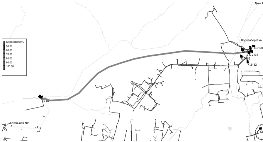
Рисунок 19 – Новый водовод между водозаборами D225.
