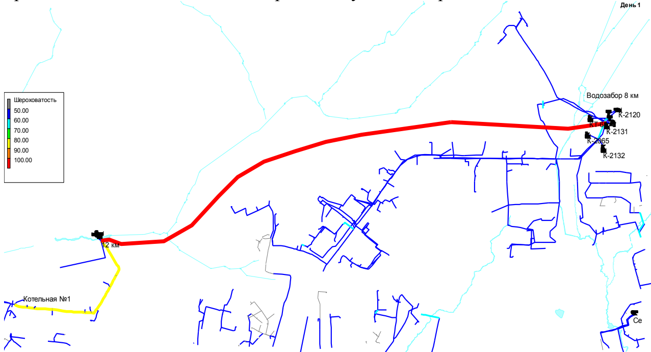
Рисунок 19 - Новый водовод между водозаборами D225.
