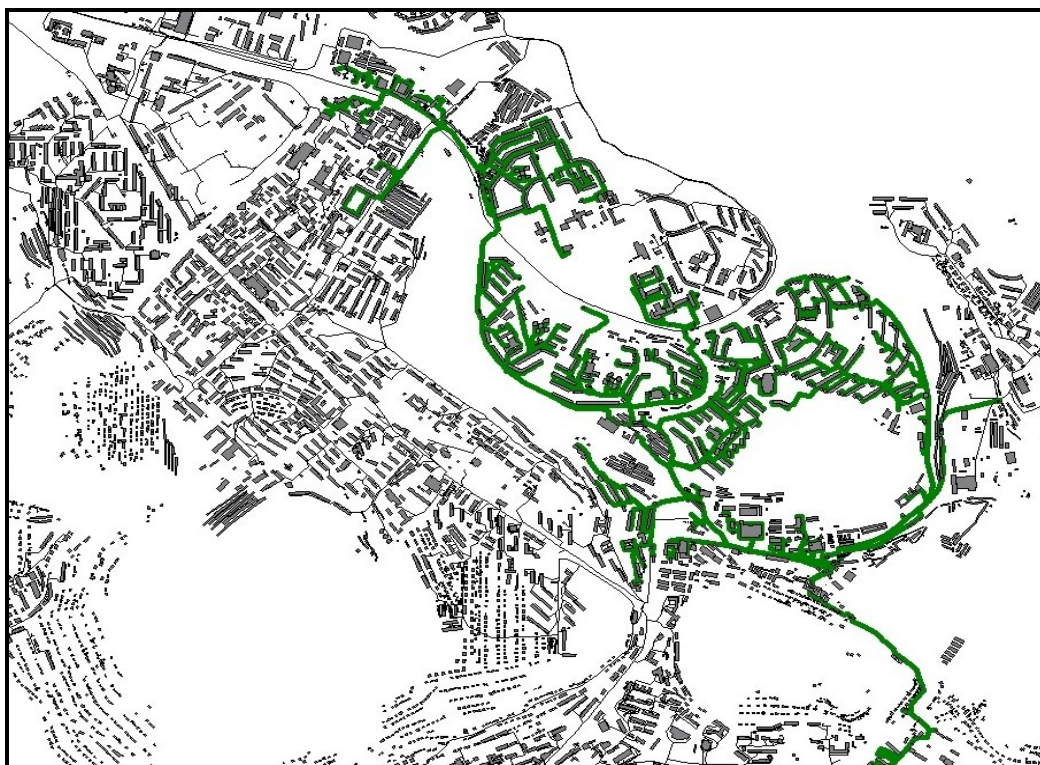
Рисунок 3 - Бассейн канализования выпуска Совхозный
